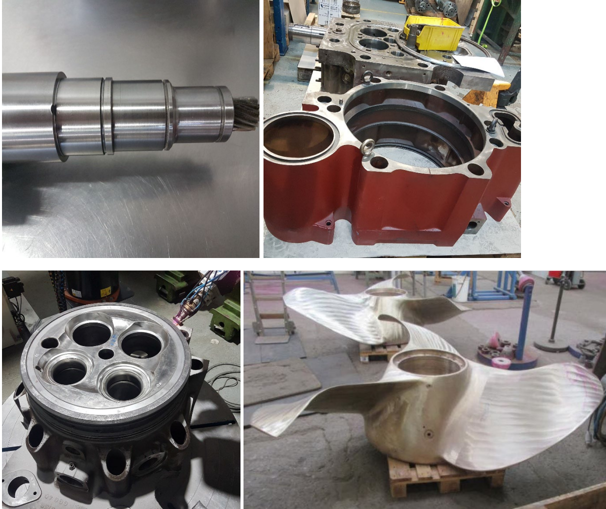
Abbildung 2. Typische Anwendungen für das Laser-Pulver-Auftragschweißen: Rekonditioniertes Wellenende (links oben), Wasserleitmäntel – Dichtflächen (rechts oben), Zylinderdeckel (links unten), Azipod-Prop (Propellergondel) mit beschädigten Innenflächen (rechts unten) (Quelle: https://www.laser-clad.de/de/anwendungen.html )
